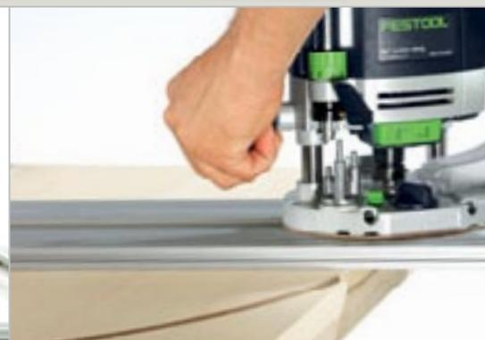
Точное фрезерование вырезов – шаблон MFS настраивается на нужный размер, закрепляется струбцинами – и вам гарантирован точный результат с высокой повторяемостью.
