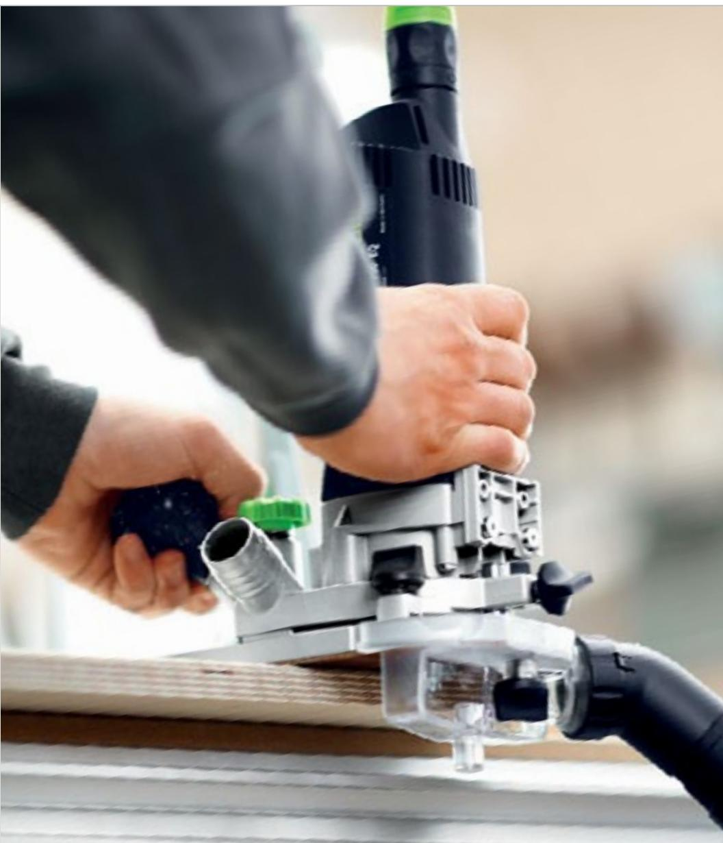
Опорные пластины 1,5° и 0°: наклон 1,5° защищает поверхность при фрезеровании. Для обработки заготовок, покрываемых шпоном или ламинатом, используется опорная пластина 0° (OFK 700/MFK 700).
