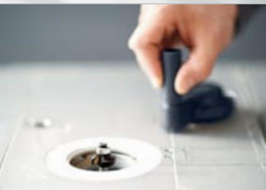
Удобная регулировка рабочей высоты фрезы при помощи съёмной рукоятки, которую можно установить под столом и над ним.
