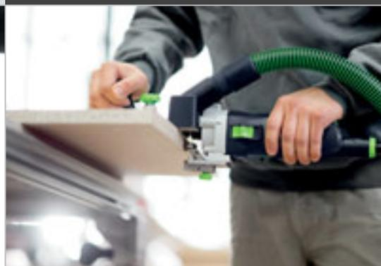
OFK 500 производит обработку при очень незначительном удалении фрезы от опорной пластины. Результат: исключается брак, фрезер не соскальзывает на углах и вы получаете в целом более высокое качество обработки.
