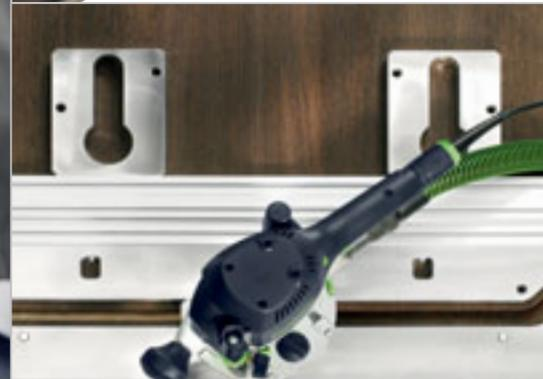
Для выборки пазов и отверстий под обычную соединительную фурнитуру с нижней стороны столешницы служат оба шаблона для выемки замочных скважин на APS.
