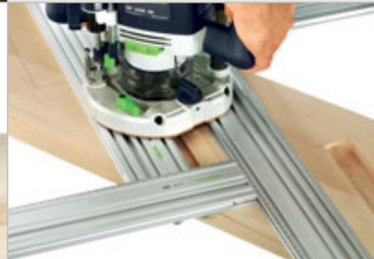
Фрезерование с помощью универсального фрезерного шаблона больших дугобразных сегментов – простая работа с удлинительным профилем. Даже если центрирующее отверстие находится за пределами заготовки.
