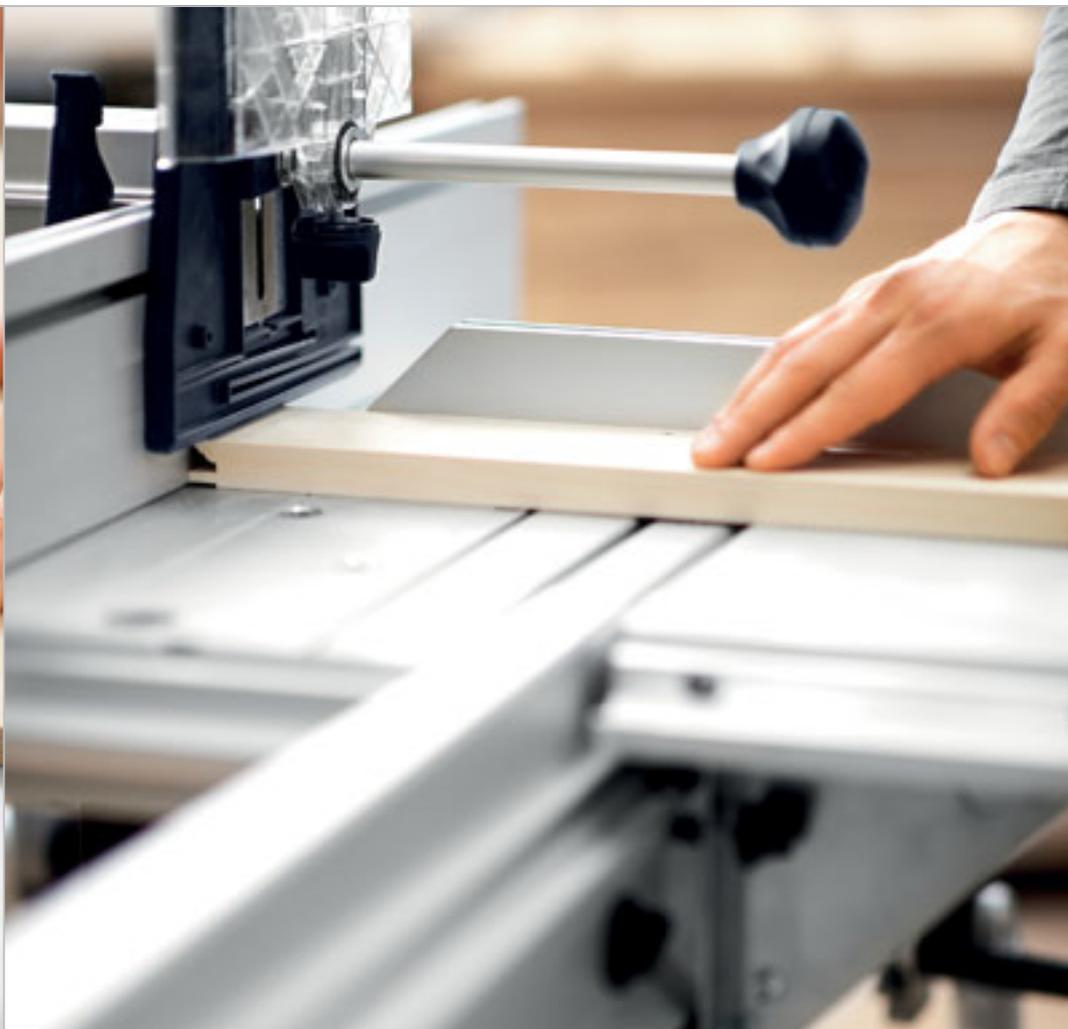
Оптимальное пылеудаление – прозрачный кожух закрывает фрезу при обработке фасонных и изогнутых заготовок и одновременно обеспечивает хороший обзор.
