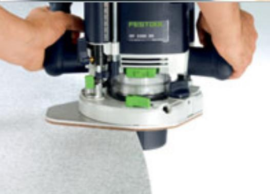
Аккуратное фрезерование кромок – с широкой подошвой для устойчивости. Возможна ее замена без инструмента обычной подошвой.
