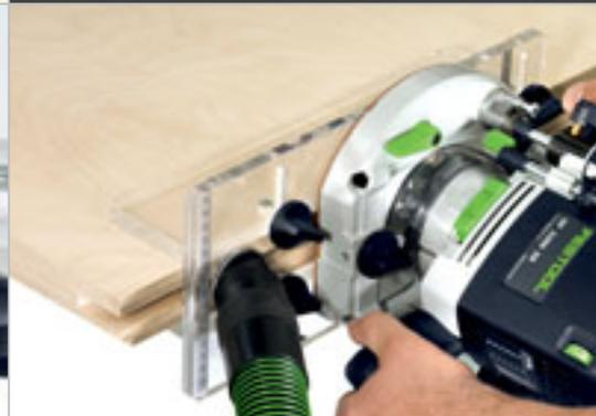
Пазы быстро и просто фрезеруются при помощи специального приспособления, например, пазы для автоматических дверных уплотнителей, защитной обивки, дверных шпингалетов и корпусов замков.
